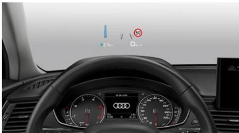
Auf Wunsch werden die Geschwindigkeit und weitere fahrerrelevante Informationen aus optional erhältlichen Ausstattungen wie Assistenzsystemen und Navigation sowie Warnhinweise in den direkten Sichtbereich der fahrenden Person projiziert. Die Blickabwendung von der Fahrbahn wird dadurch reduziert. Die mehrfarbige Anzeige ermöglicht eine kontraststarke Darstellung. Die Projektionsfläche des dezent in die Instrumententafel integrierten Head-up-Displays ist in der Höhe und Helligkeit einstellbar.
